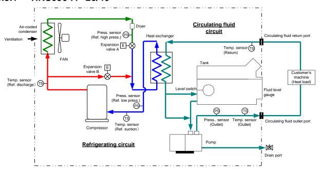
Fig. 9-3 Flow diagram(HRS090-A\*-20/40\*)
